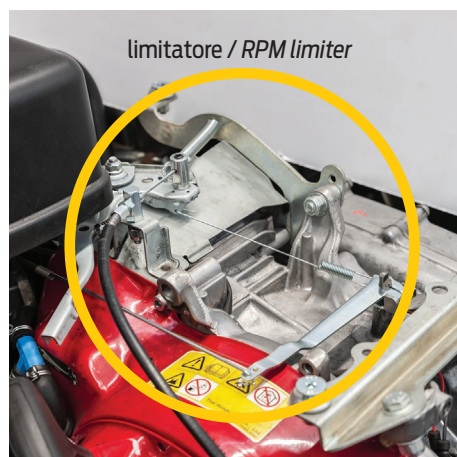
limitatore / RPM limiter Motore Honda 390 +riduttore e limitatore RPM Engine Honda 390 complete with adapter and RPM limiter
